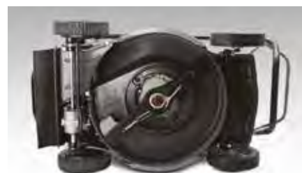
Chasis de acero / Embrague de cuchilla
